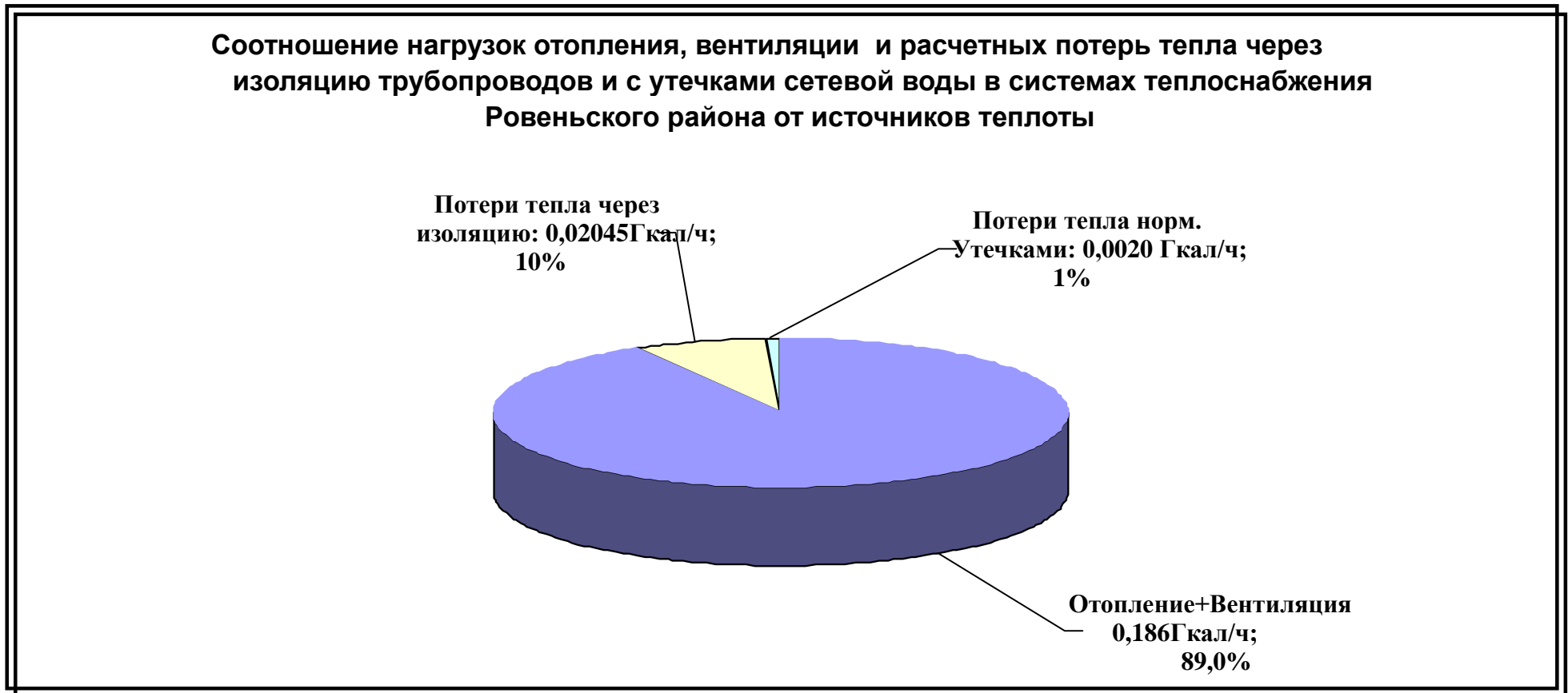
Рис.1.3.Соотношение нагрузок отопления, вентиляции и расчетных потерь в системах теплоснабжения Ровеньского района от всех источников теплоты
