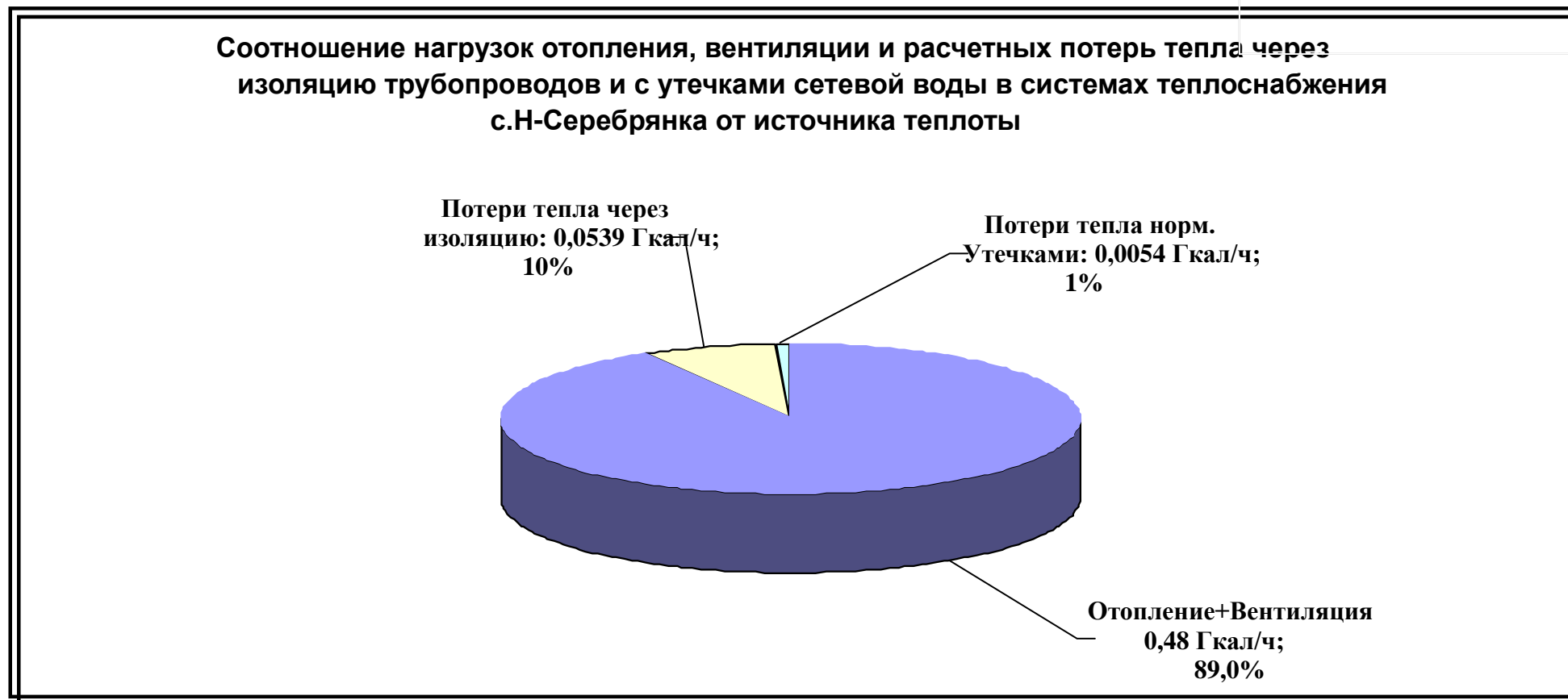
Рис.1.3.Соотношение нагрузок отопления, вентиляции и расчетных потерь в системах теплоснабжения с.Н-Серебрянка от источника теплоты
