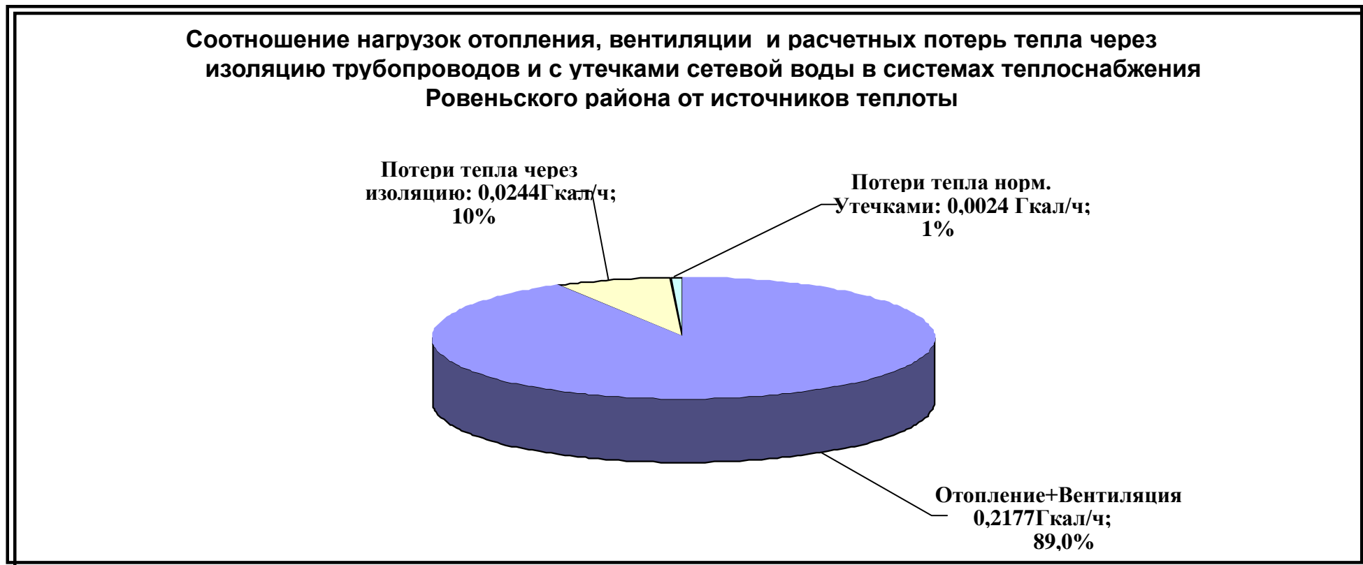
Рис.1.3.Соотношение нагрузок отопления, вентиляции и расчетных потерь в системах теплоснабжения Ровеньского района от всех источников теплоты
